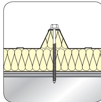
Grazie alla perfetta configurazione del giunto, oltre a rendere piacevole ed uniforme la superficie dell'involucro edile, il pannello Isolpack è in grado di abbattere considerevolmente i ponti termici che, come è noto, sono causa di dispersione energetica e formazione di condensa.
